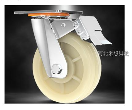
脚轮安装方式:一般中轻载可用丝杆、插杆、膨胀胶套等,重载则用底板,或者直接焊接到设备上。一般大公司的安装方式很丰富。1、刹车:从功能上来说,有刹轮子的,有刹支架万向的,两者同刹则为双刹,还有胎面刹,正刹,边刹等,具体联系脚轮工厂。2、脚轮在设备上的布置:布置方式不一样,不但影响成本,推动的感觉也很大不同!3、支架选择:分为定向和万向,材质一般用碳钢,可进行各种电镀,如镀锌,镀铜,镀镍,镀铬,喷涂等,也有用不锈钢的。4、看承重:同一种直径的脚轮,一般厂家都会生产几个系列用于不同的承重,如轻型,中型,中型等,方法是让轮子和支架有不同的厚度或者材质。算单个脚轮的负荷时要给予一定的保险系数,在地面比较平整时,单个脚轮负荷=(设备总重÷所装脚轮数量)×(保险系数);如果地面不平整,则算法为,单个脚轮负荷=设备总重÷3,因为不论哪种非平整地面,总是至少有三个轮子同时支撑设备,这种算法等于增加了保险系数,更加可靠,防止承重不足,导致脚轮寿命很大减少或导致事故。5、轮子材质:这个很重要,一般有PU,TPR,PP,橡胶,尼龙等,至于适用温度、表面硬度、地面环境等。
